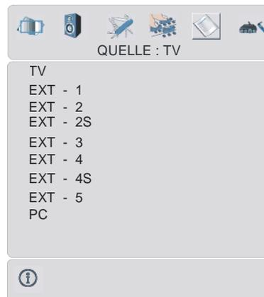
Heben Sie im Menü Quelle über die Taste ▲ / ▼ eine Quelle hervor und wechseln Sie in diesen Modus, indem Sie auf die Tasten ◀ / ▶ oder „OK“ drücken.
