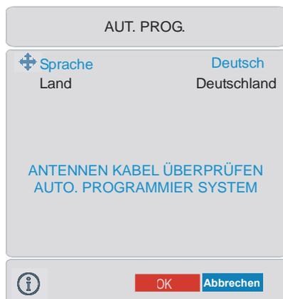
Wählen Sie zuerst mit den Tasten **▲ / ▼** and **◀ / ▶** die **Sprache** und das **Land** aus. Dies beeinflusst den Sortierungsvorgang im APS. Drücken Sie die Taste **ROT** oder **„OK“**, um A.P.S. zu starten.
