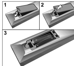
**ACHTUNG:** Nehmen Sie die Batterien aus der Fernbedienung heraus, wenn das Gerät längere Zeit nicht benutzt wird. Die Fernbedienung könnte durch auslaufende Batterien beschädigt werden.
