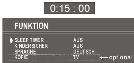
Die letzte Minute im Countdown des Sleep Timer wird **rechts** oben automatisch eingeblendet. Die Anzeige erlischt, wenn der Sleep Timer abgelaufen ist. Anschließend schaltet das TV-Gerät automatisch in den Bereitschaftsmodus.
