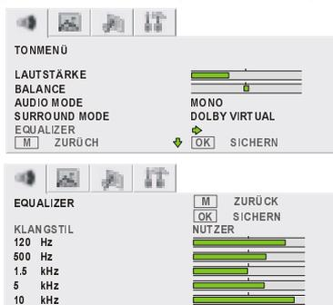
Mit der Taste "▽" wird die gewünschte Frequenz ausgewählt, und mit "◁" oder "▷" wird der Pegel dieser Frequenz erhöht oder verringert. Drücken Sie die Taste "OK", um die Equalizer-Einstellungen zu speichern. Drücken Sie Taste "M", um das Equalizer-Menü zu verlassen.
