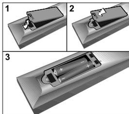
**HINWEIS:** Nehmen Sie die Batterien aus der Fernbedienung heraus, wenn diese für längere Zeit nicht benutzt wird. Andernfalls kann diese durch auslaufende Batterien beschädigt werden.
