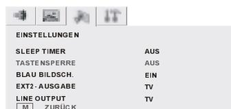
Wenn **TASTENSPERRE EIN** geschaltet ist, und es wird eine der Tasten am vorderen/rechten Bedienfeld gedrückt (außer der Einschalttaste), erscheint ein warnendes Menü in der unteren Mitte des Bildschirms.
