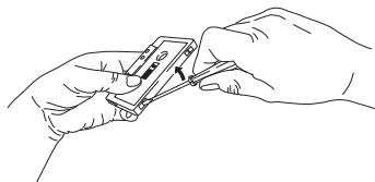
Bei bespielten Kassetten der Industrie sind diese Zungen bereits entfernt. Ein nachträgliches Löschen ist trotzdem möglich, wenn Sie vor einer Neuaufnahme die Öffnung mit Plastik-Klebeband überkleben.
