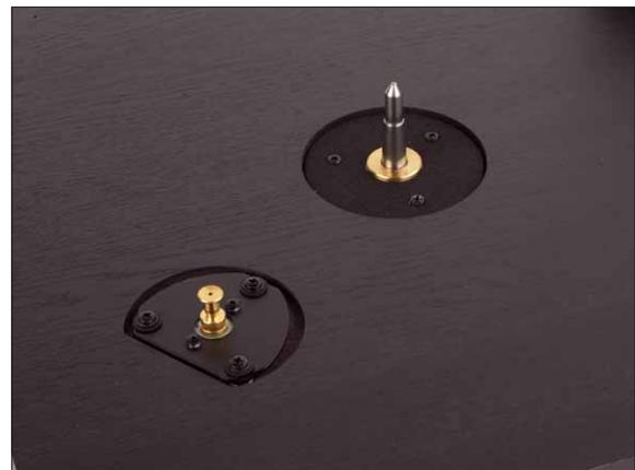
*Der Gleichstrommotor sitzt entkoppelt in der Zarge, in deren Mitte das bewährte Dual-Tellerlager montiert ist*
