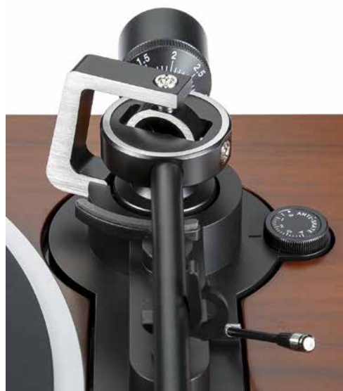
Die kardanische Tonarmaufhängung erinnert an frühere Zeiten. Sie ist sehr präzise. Dies gilt auch für das Gegengewicht; Anti-Skating per Federzug.
