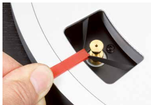
Das rote Band gehört zum Lieferumfang und erleichtert das Umlegen des Riemens auf das Motorpulley.
