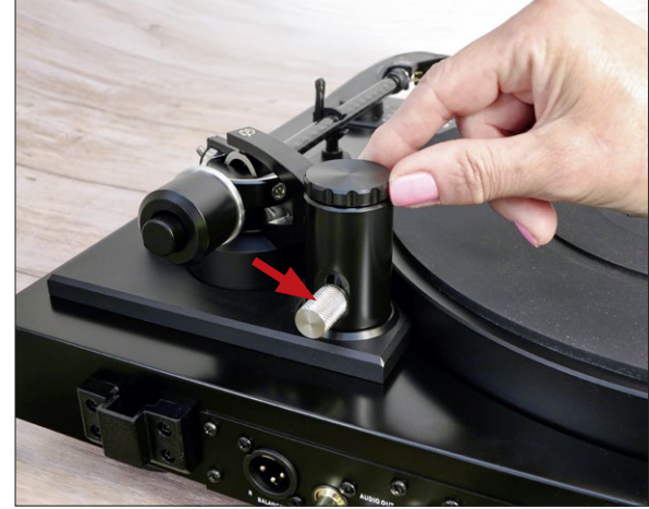
Nach Lösen des Haltebolzens (Pfeil) lässt sich die Armbasis per Rändelschraube vertikal bewegen.
