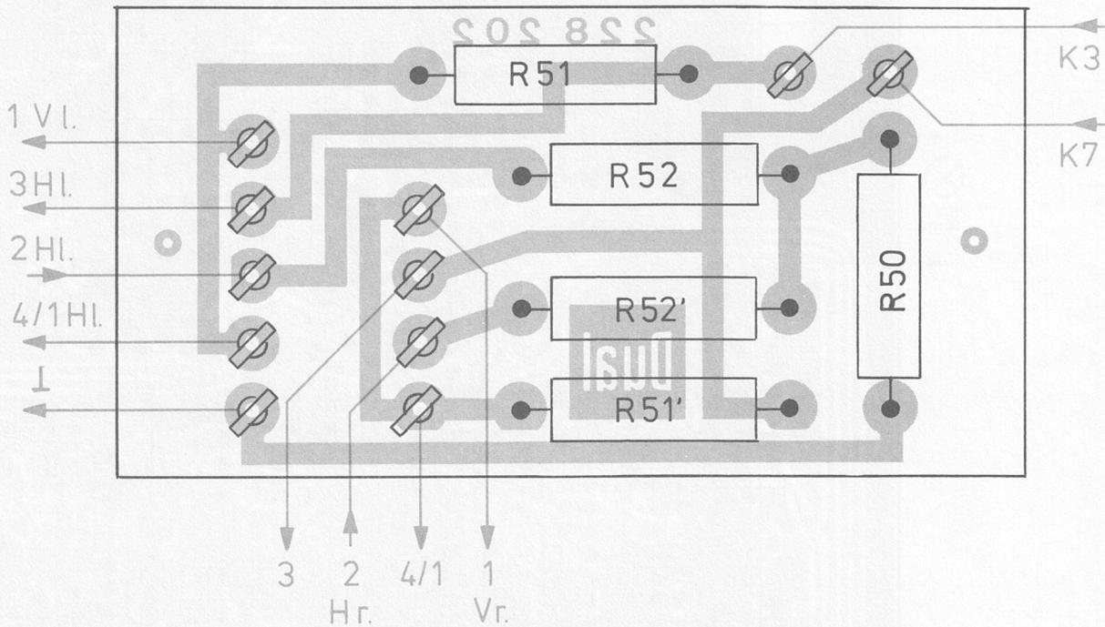
Fig. 10 Netzanschlußplatte 224 505 (Bestückungsseite)
