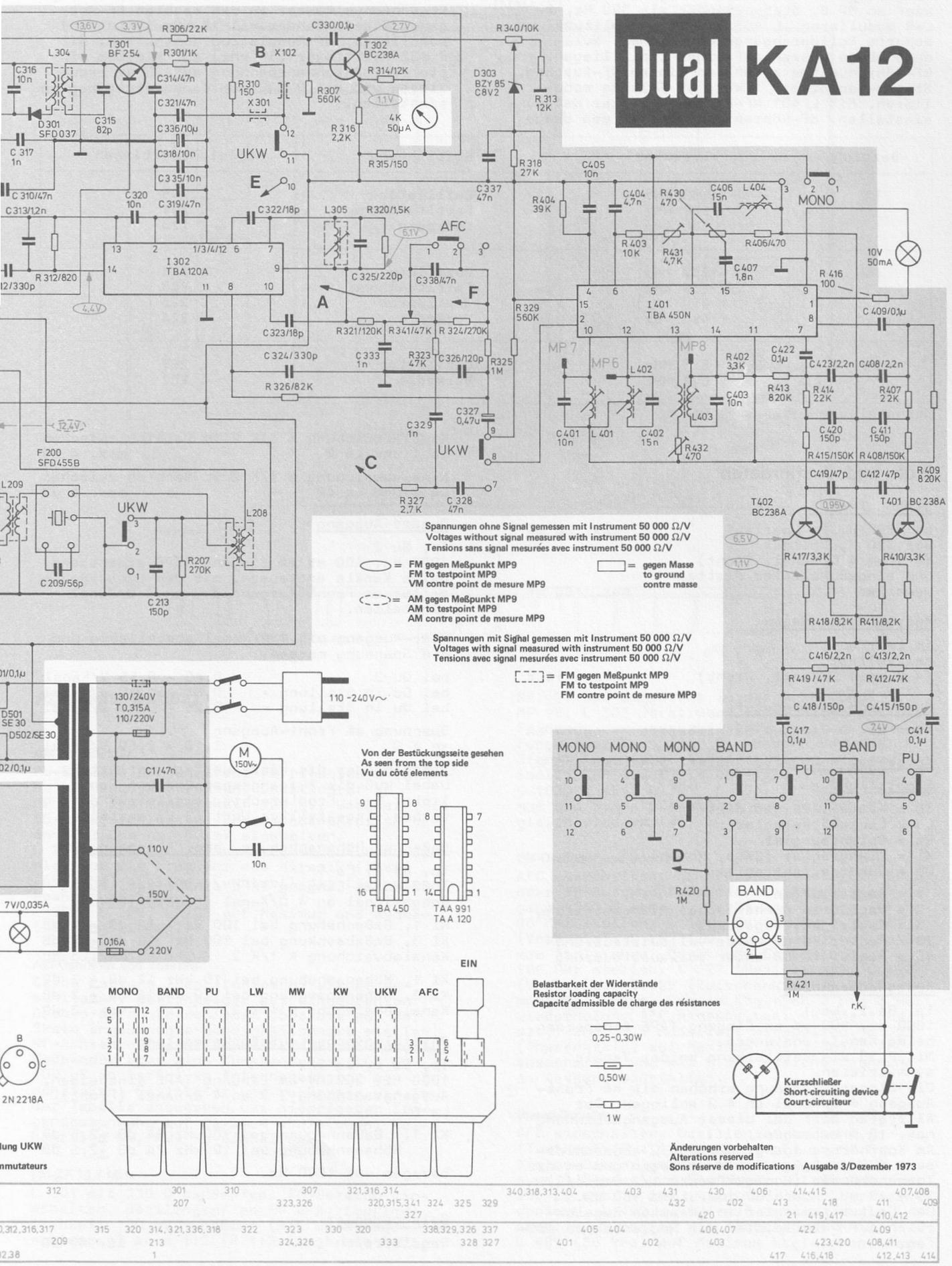
Spannungen ohne Signal gemessen mit Instrument 50 000 Ω/V
