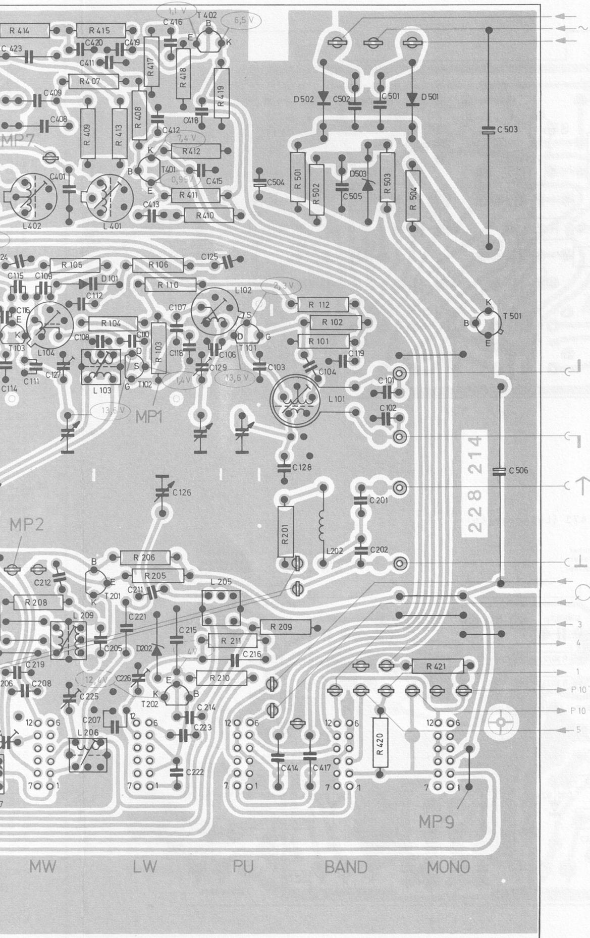
Fig. 7 Regelverstärker 231 253 (Leiterseite)
