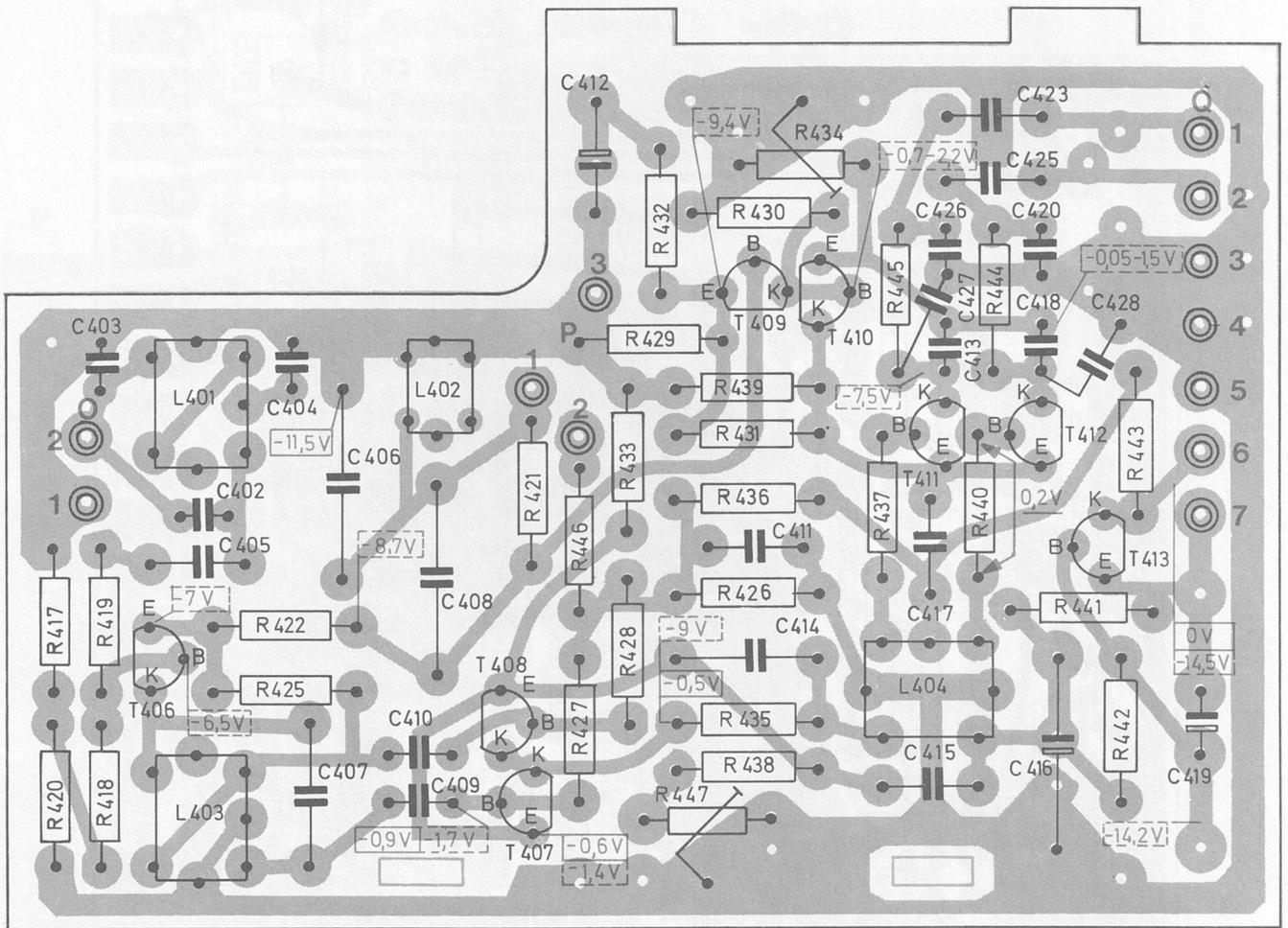
Fig. 7 Lautsprecheranschlußplatte 234 475 (Leiterseite)
