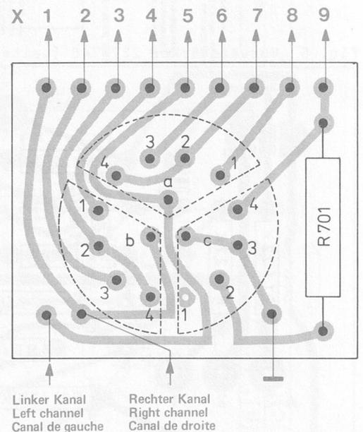
Fig. 9 Regelverstärker 230 606 (Leiterseite)
