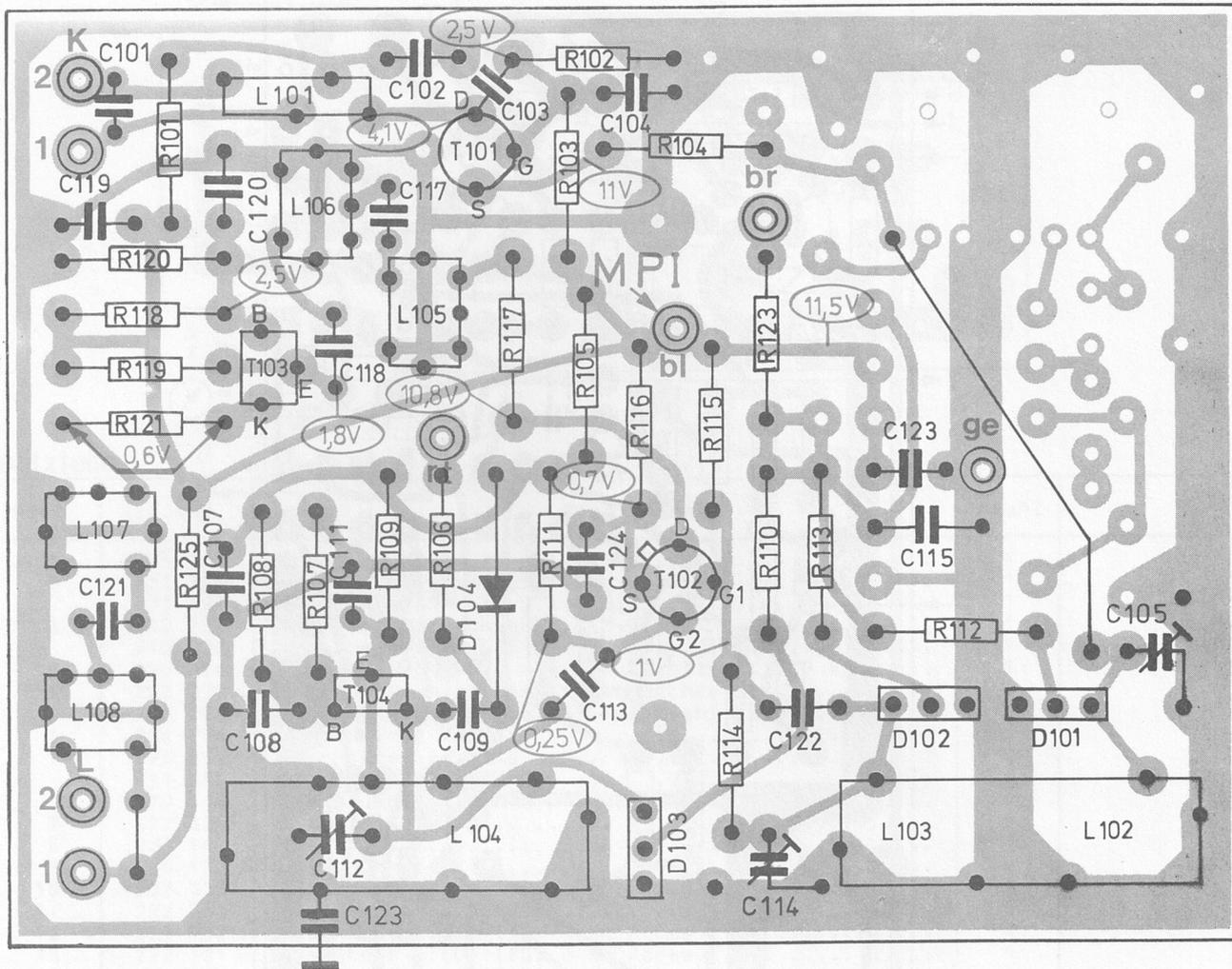
Fig. 12 Netzanschlußplatte 212 600 (Bestückungsseite)
