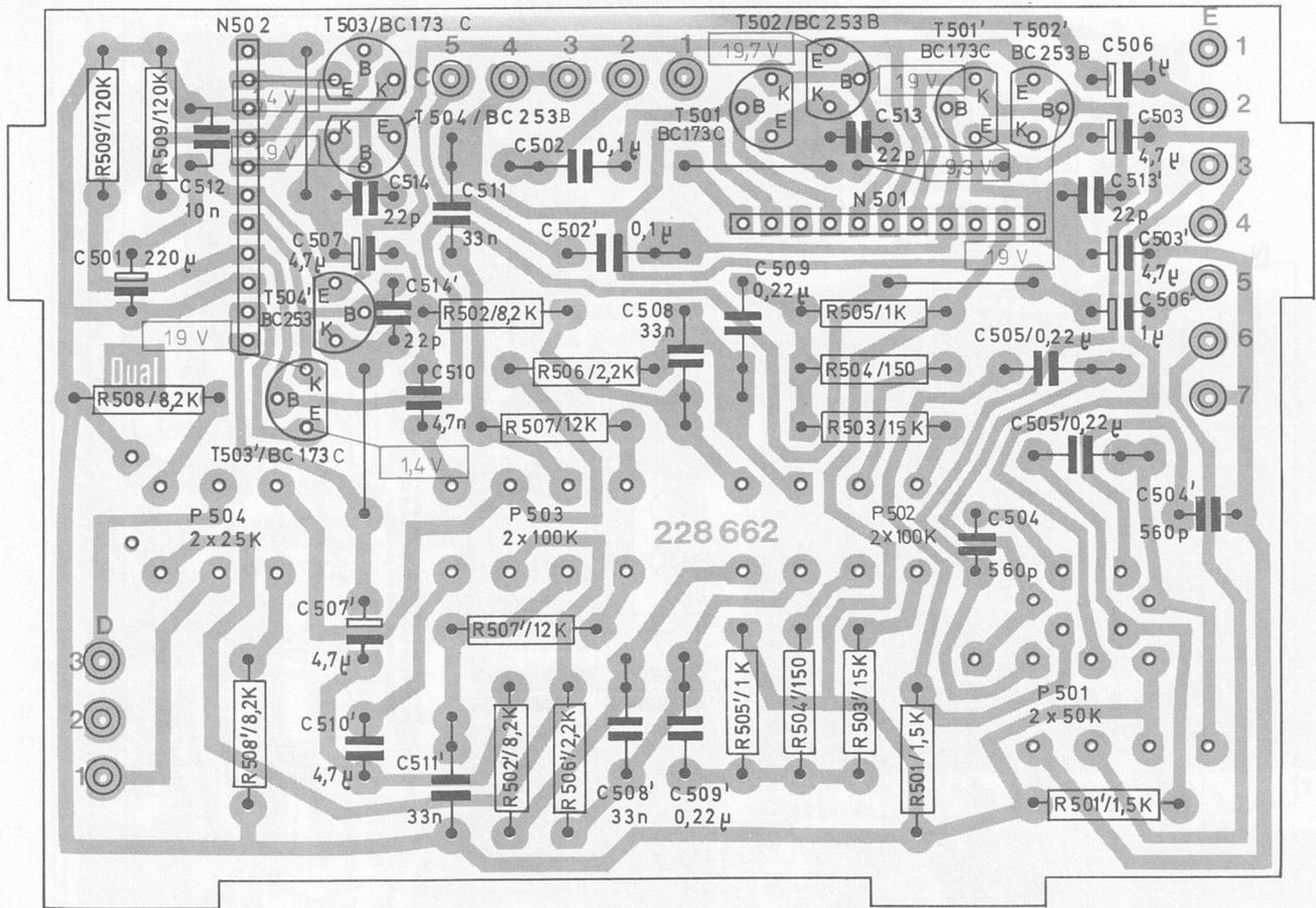
Fig. 10 Endverstärker 234 147 (Leiterseite)
