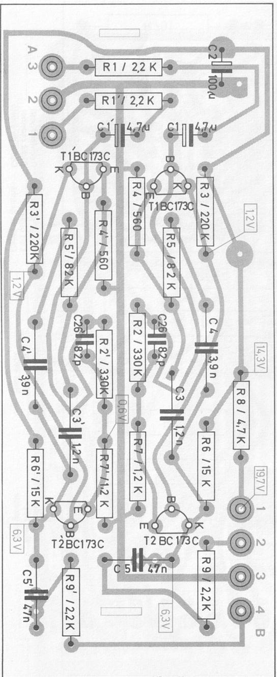
Fig. 5 Vorverstärker 227 746 (Leiterseite)
