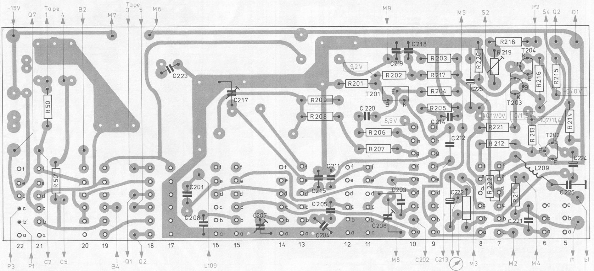
Fig. 14 Gleichrichterplatte 231 217 (Leiterseite)
