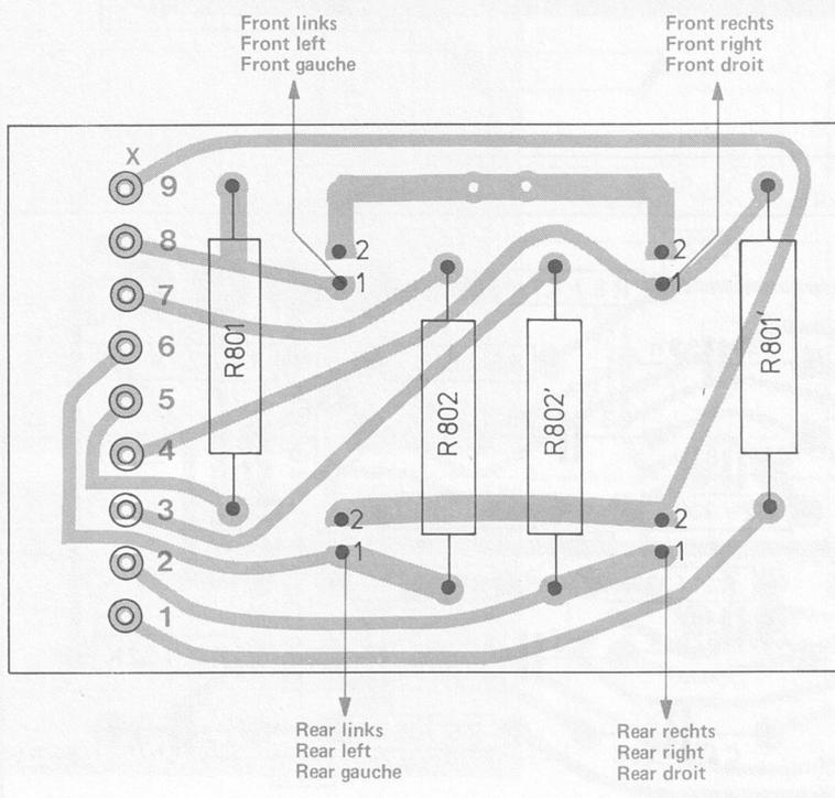
Fig. 8 Betriebsartenschalterplatte 234 473 (Leiterseite)
