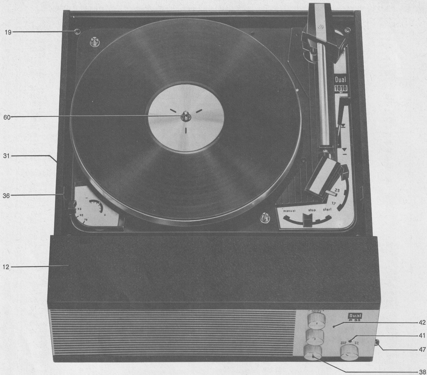
Fig. 6 Koffer, Bedienungselemente und Beschlagteile für Dual P 52
