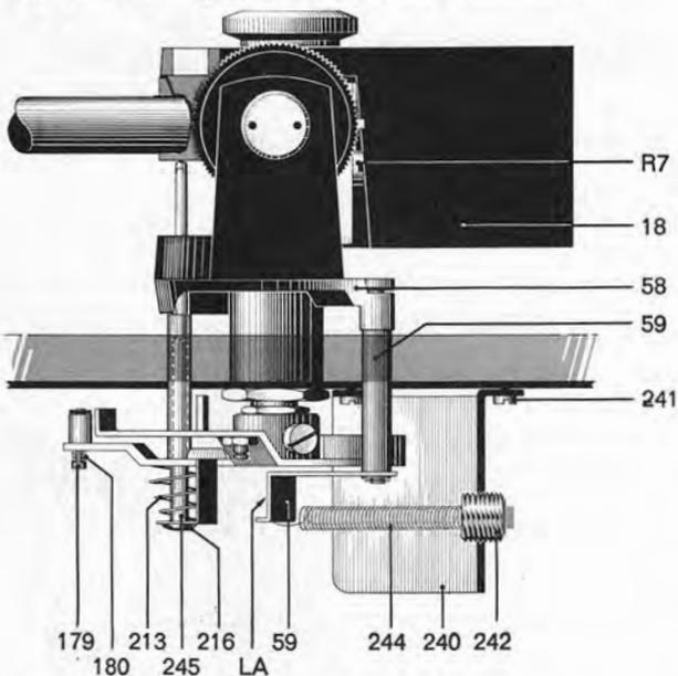
Fig. 7 Tonarmlagerung (Unteransicht)
