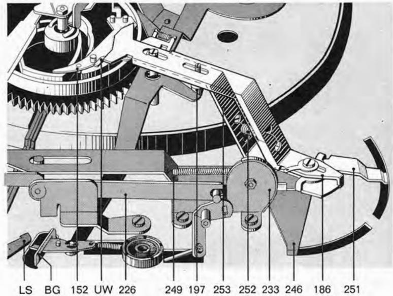
Fig. 15 Schallplattenabwurf
