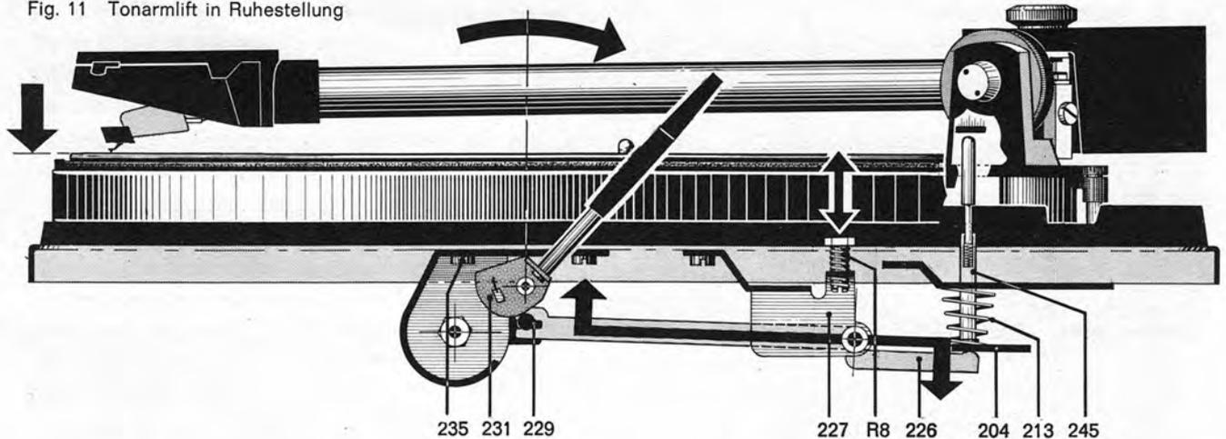
Die Höhe der Abtastnadel über der Schallplatte läßt sich durch Drehen der Stellschraube (R 8) im Bereich von 0—6 mm variieren. Durch Rechtsdrehen wird der Abstand
