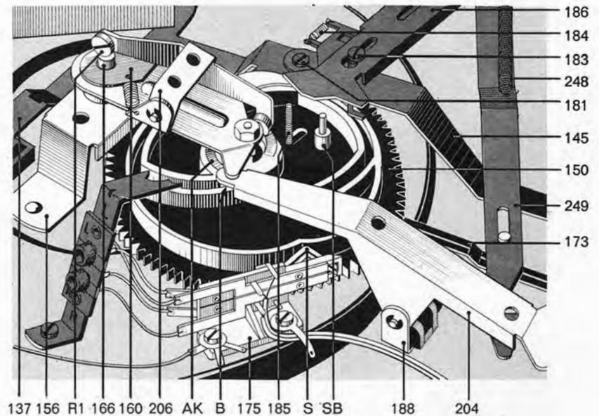
Abwurf einer Schallplatte nur erfolgen kann, wenn sich der Tonarm über der Stütze, also außerhalb des Bereiches des größtmöglichen Schallplatten-Durchmessers (30,5 cm), befindet.
