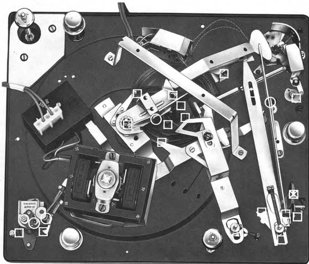
Fig. 28 Schmierstellen unter der Platine
