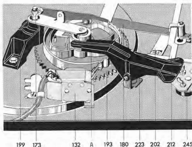
Fig. 17 Einleitung der Wechsel- bzw. Abstellfunktion
