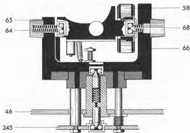
Fig. 8 Tonarmlagerung (Unteransicht)
