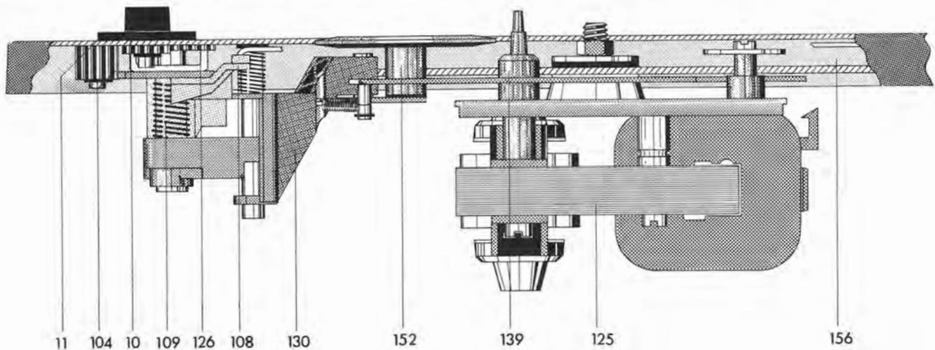
Fig. 3 Motoraufhängung und Antrieb des Plattentellers Dual 1225
