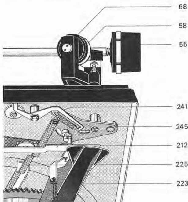
Das Ausgleichgewicht ist so bemessen, daß Tonabnehmersysteme mit einem Eigengewicht von 1 - 10 Gramm balanciert werden können.
