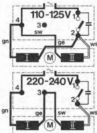
Spule II nicht in 2-Pol-Motor, der je nach Ausführung nur für 220 V/110 V oder 150 V verwendbar ist.
