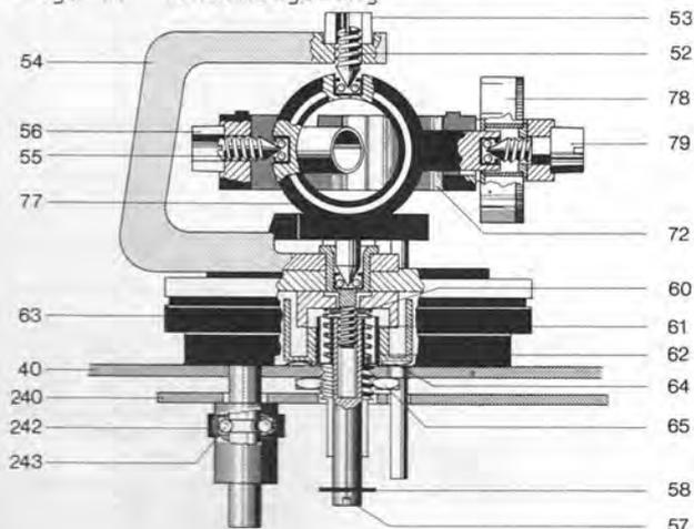
Fig. 12 Tonarmlagerung Unteransicht
