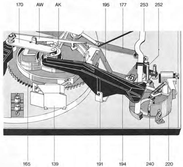
Dadurch wird die Stellschiene (253) frei und der Tonarm wird über den viskositätsgedämpften Heberbolzen langsam abgesenkt.
