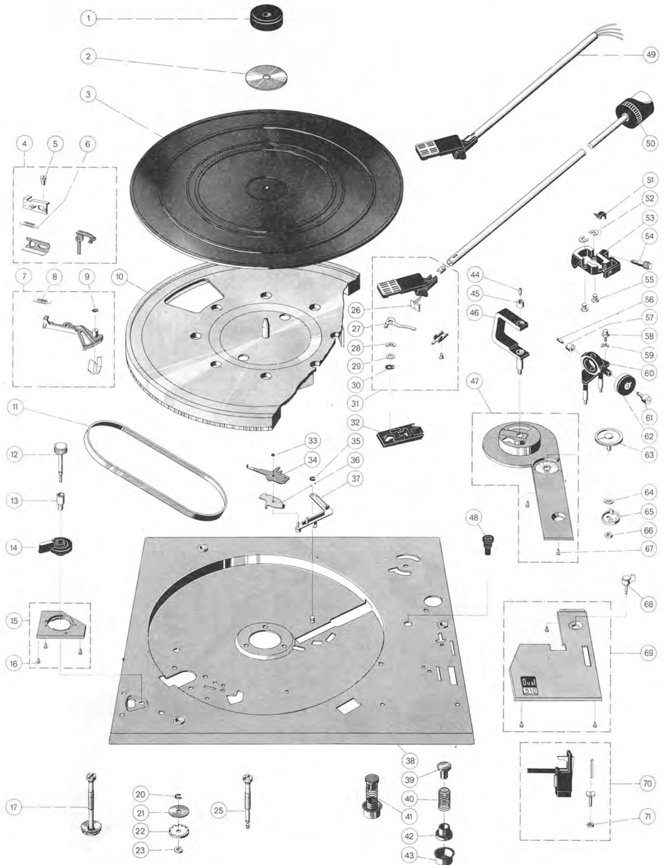
Fig. 19 Explosionsdarstellung, Teile über der Platine
