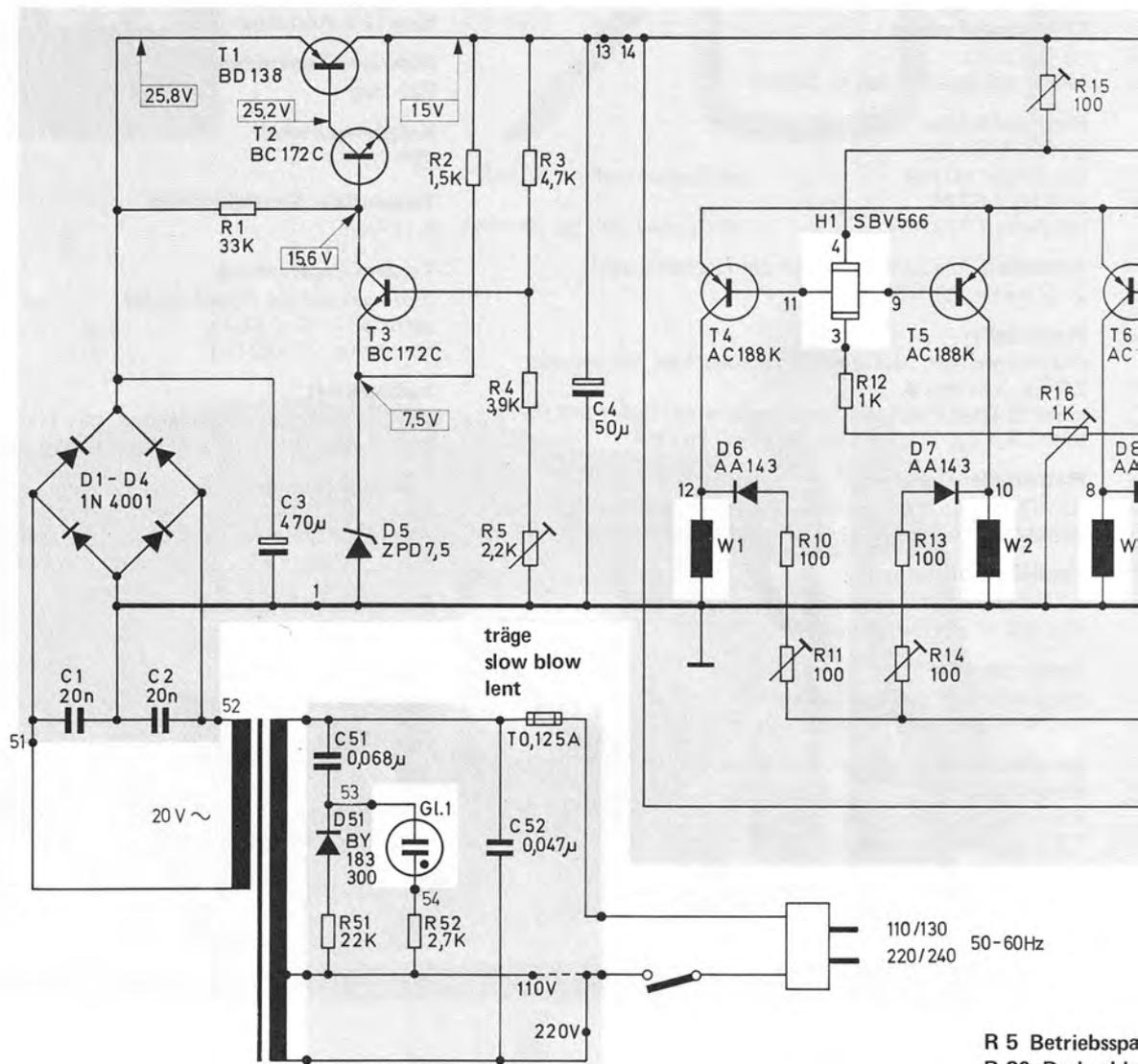
Spannungen gemessen mit Meßinstrument (7 – 10 MOhm Eingangswiderstand) gegen Masse
