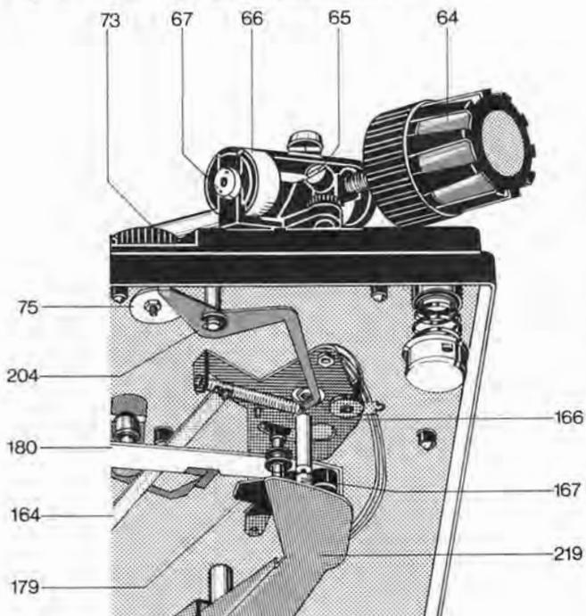
Er gewährleistet dadurch besonders günstige Abtastbedingungen. Der Tonabnehmerkopf ist abnehmbar. Vor der Einstellung der dem eingebauten Tonabnehmersystem entsprechenden Auflagekraft wird bei 0-Stellung der Skala der Tonarm ausbalanciert. Die Grobeinstellung erfolgt durch Verschieben des Gewichtes (64) mit Dorn, die nachfolgende Feinjustierung durch Verdrehen des Gewichtes.
