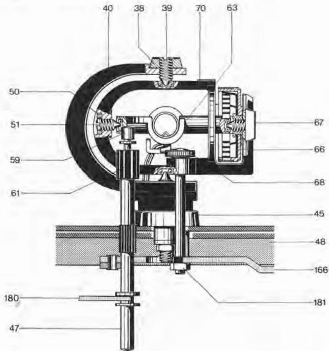
Fig. 12 Tonarmlagerung (Unteransicht)
