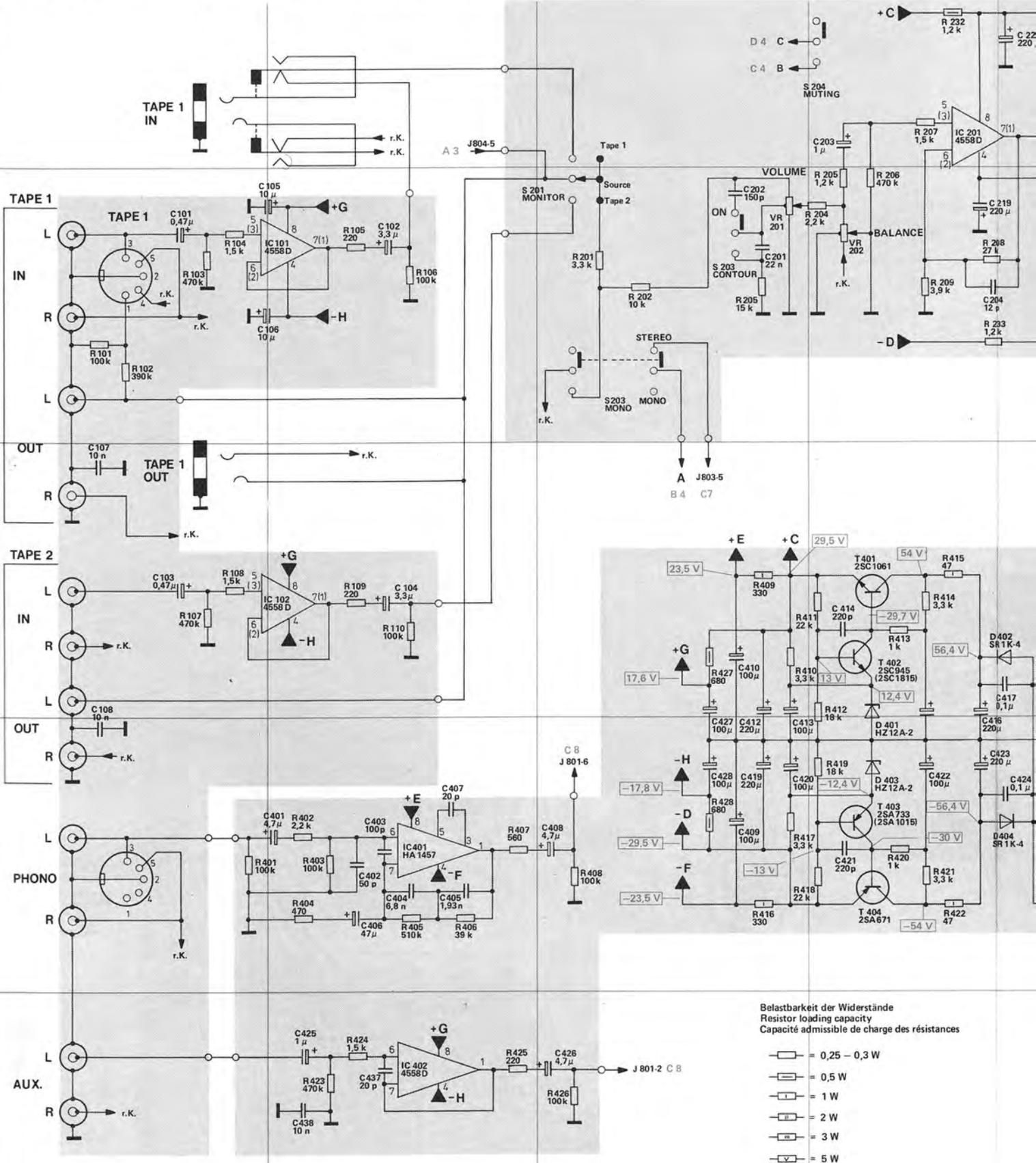
Spannungen ohne Signal gemessen mit Digitalvoltmeter ( $R_i = 10\text{ M}\Omega$ ) gegen Masse.
