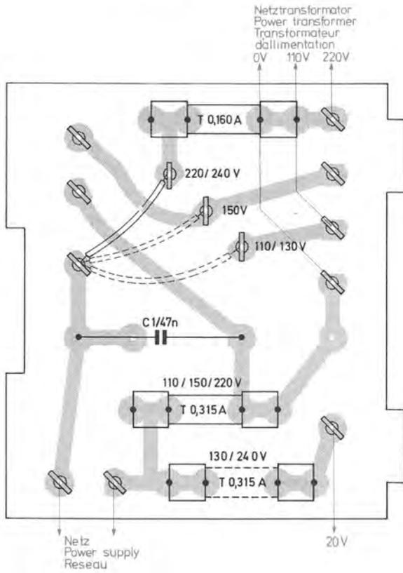
Fig. 5 Anschlußplatte für Ferritantenne
