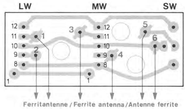
Fig. 7 Seilschema
