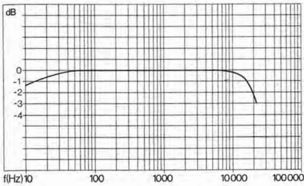
Fig. 4 Frequenzgang des Vorverstärkers
