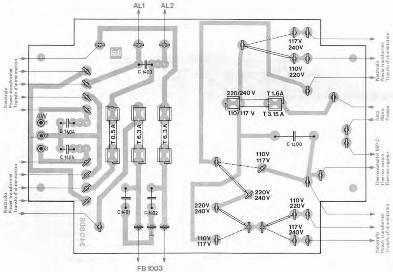
Fig. 23 Klangumschaltplatte (Leiterseite)
