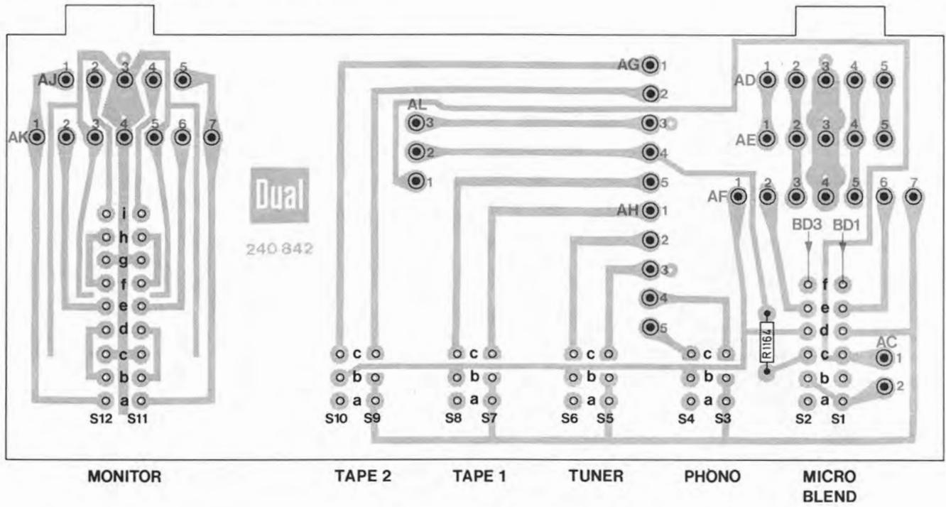
Fig. 22 Trafo-Anschlußplatte 243 758 (Bestückungsseite)
