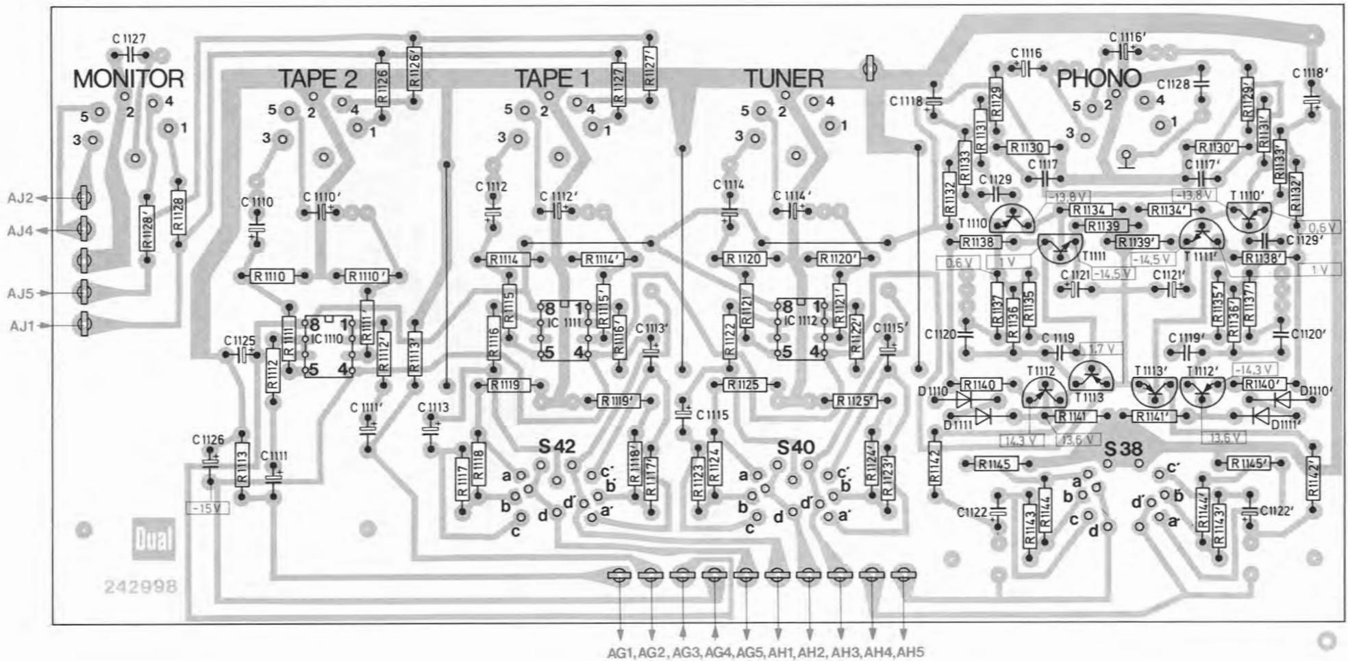
Fig. 3 Steuerverstärker 246 732 (Bestückungsseite)
