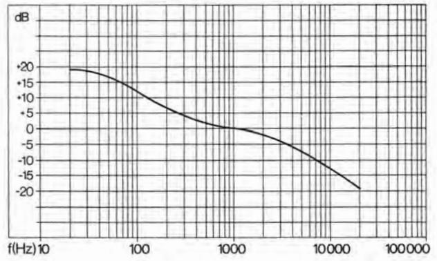
Fig. 5 Frequenzgang Eingang Tuner 1
