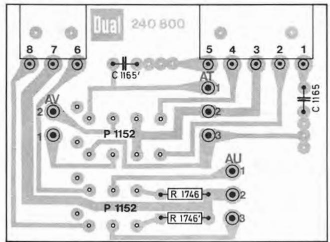
Fig. 25 Mikrofon-Regler 243 762 (Leiterseite)
