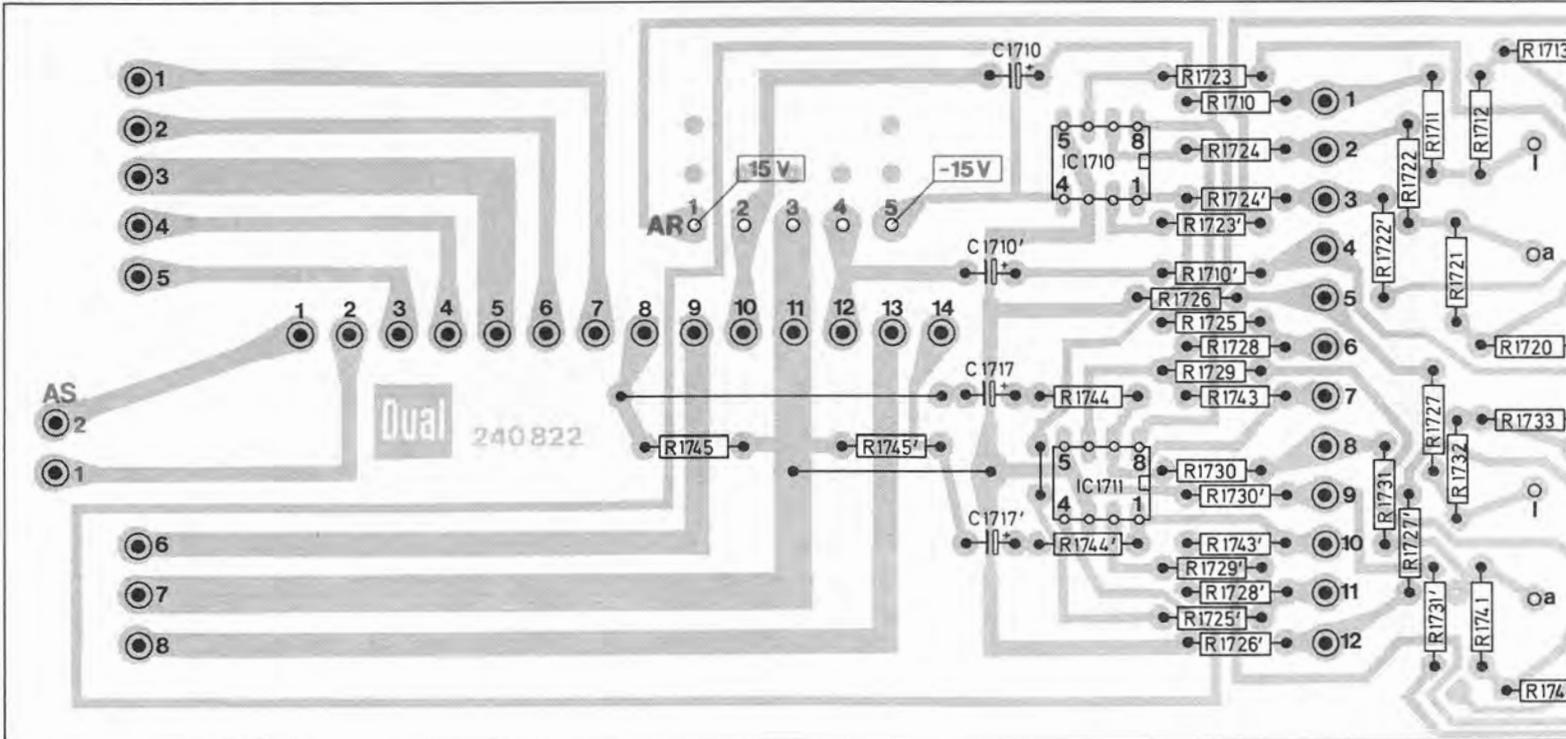
Fig. 16 Eingangsimpedanzwandler 243 759 (Leiterseite)
