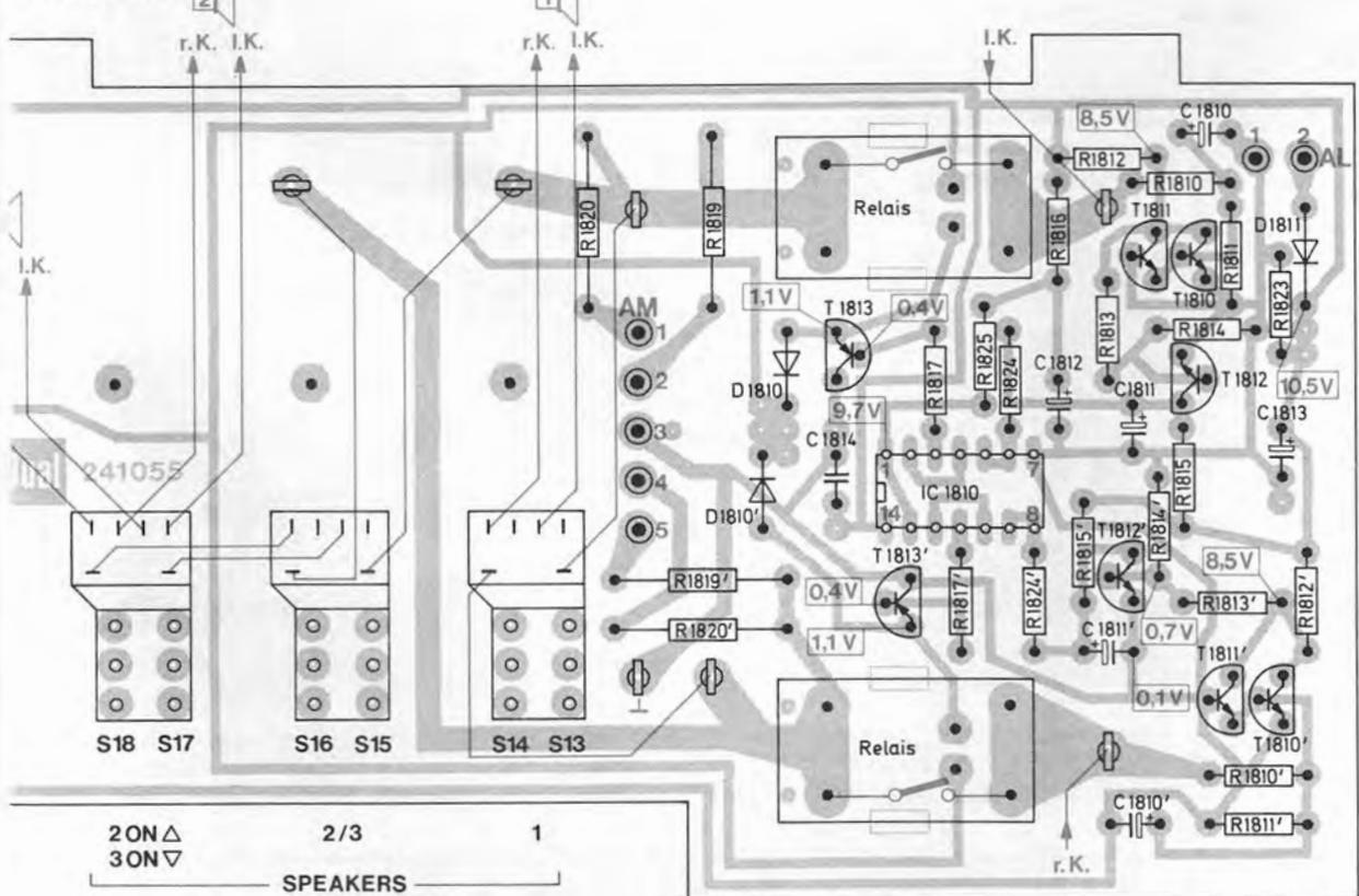
Fig. 18 Endverstärker 243 761 (Bestückungsseite)
