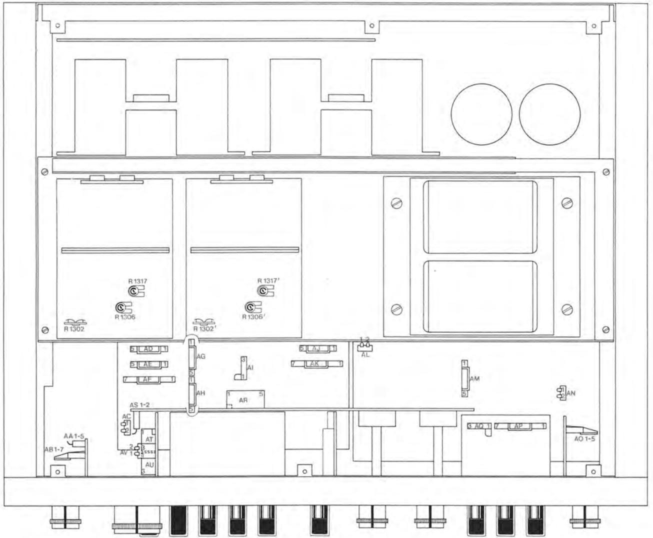
Fig. 12 Lageplan der Steckverbindungen (Geräteunterseite)
