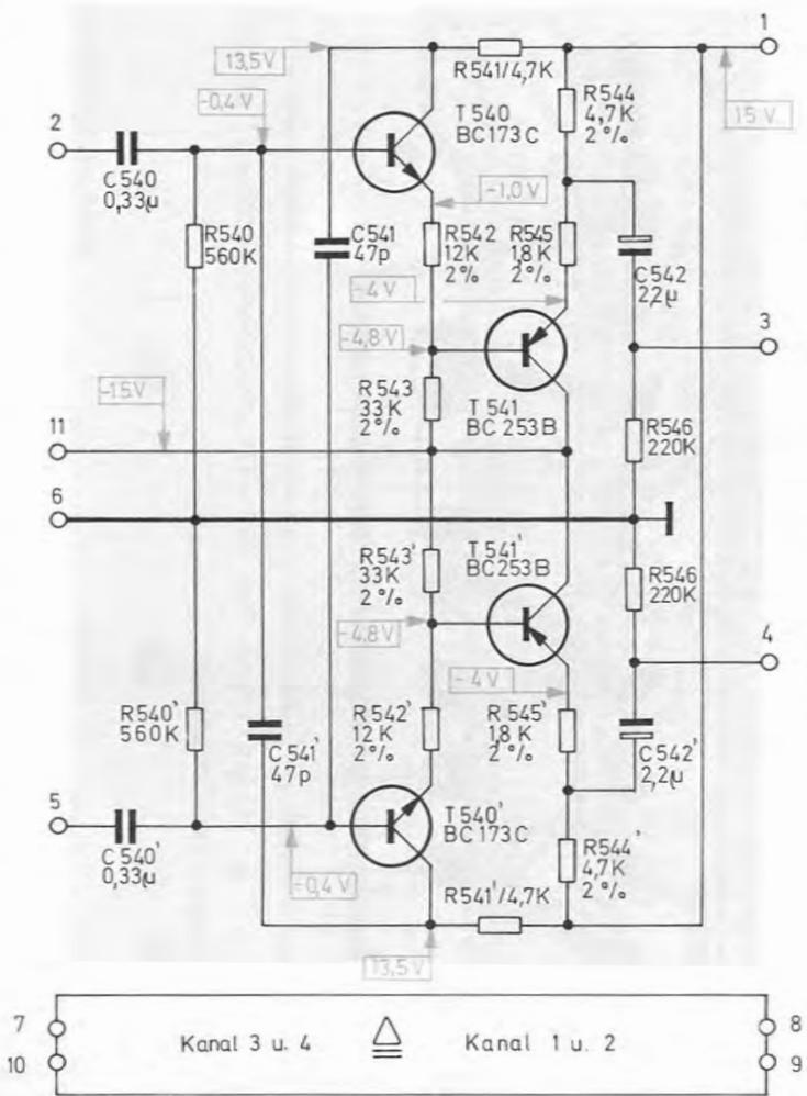
Fig. 27 Eingangsimpedanzwandler 232 463 (Leiterseite)
