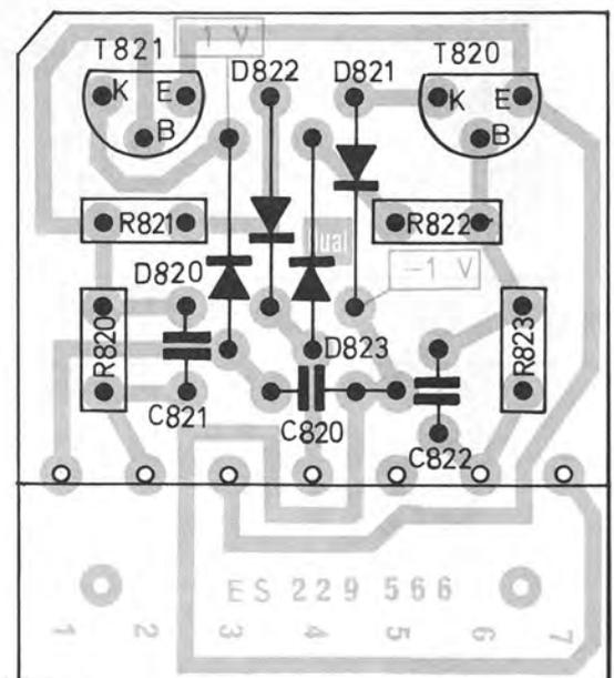
Fig. 42 Stromversorgung mit Stabilisierung X Schaltbild
