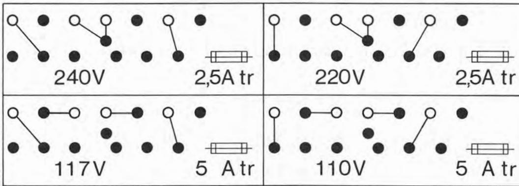
Fig. 25 Trafoanschlußplatte sec. 229 609 (Bestückungsseite)
