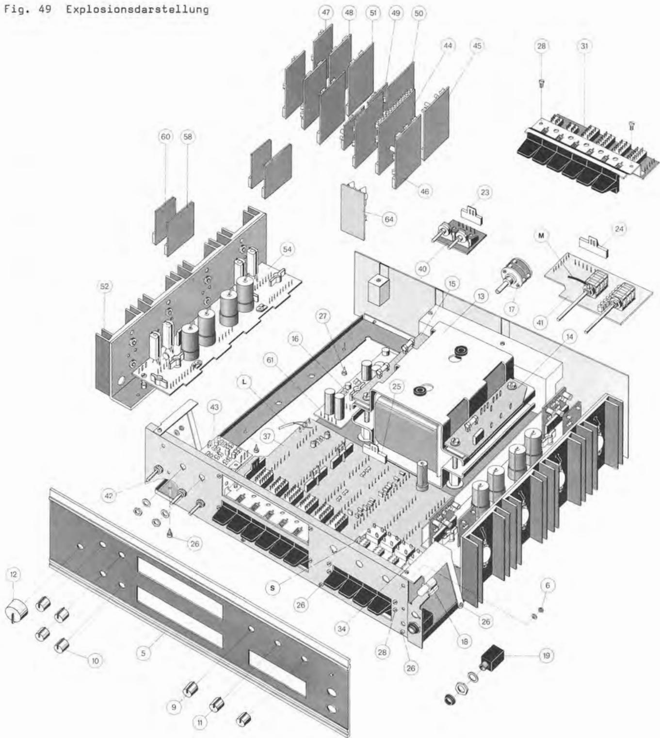
Montagehinweise zum Ausbau von Tastenaggregat, Klangregler und Steuerverstärker
