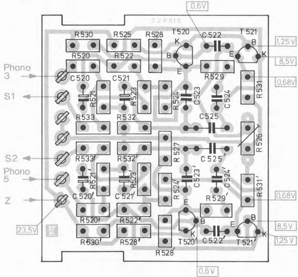
Fig. 17 Regelverstärker 233 049 (Leiterseite)
