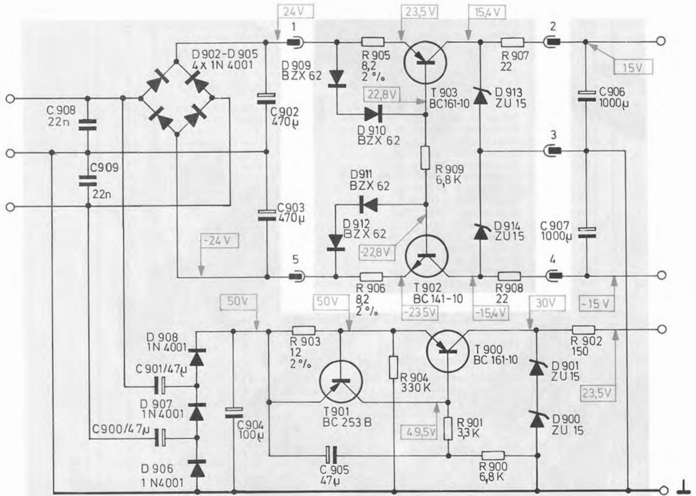
Fig. 43 Stromversorgung 233 974 (Leiterseite)
