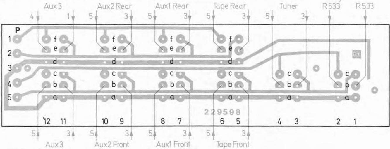
Fig. 20 Kopfhöreranschlußplatte 233 041 (Leiterseite)
