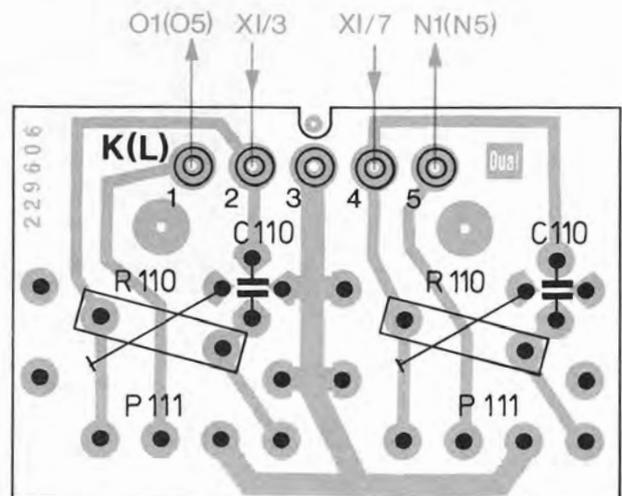
Fig. 23 Trafoanschlußplatte prim. 229 603 (Bestückungsseite)
