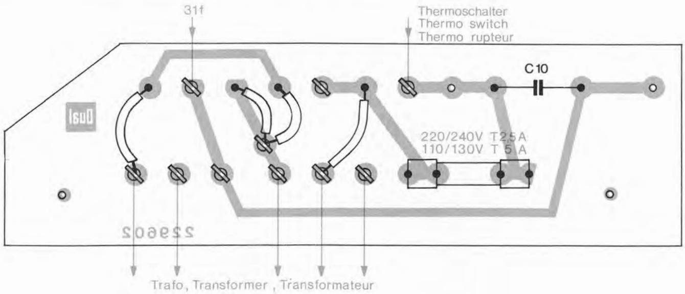
Fig. 24 Anschlußschema 110, 130, 220, 240 V
