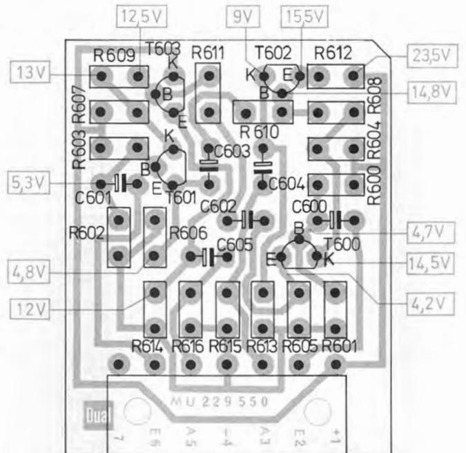
Fig. 32 IC-Verstärker V
