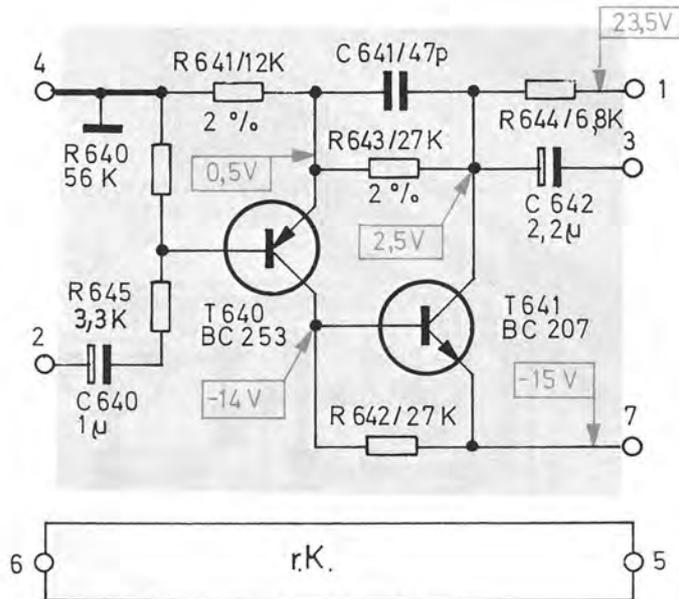
Fig. 37 Zwischenverstärker VII
