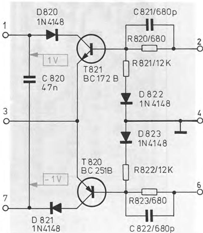
Fig. 41 Elektronische Sicherung IX
