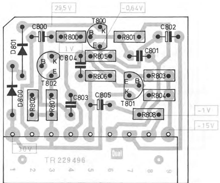
Fig. 40 Elektronische Sicherung IX
