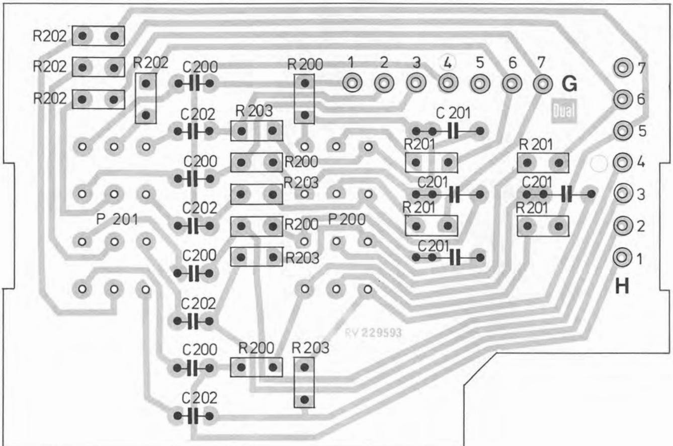
Fig. 18 Endverstärker 233 967 (Leiterseite)
