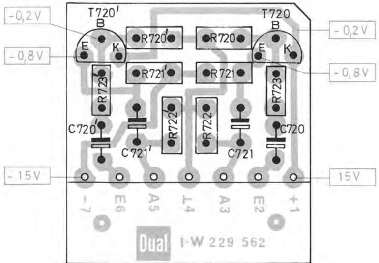
Fig. 36 Zwischenverstärker VII
