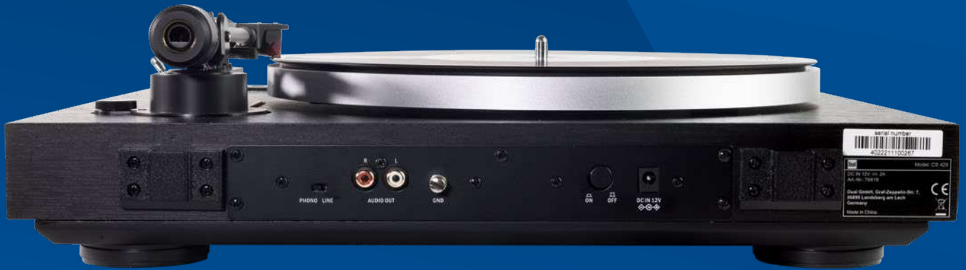
Der CS 429 setzt auf einen Riemenantrieb. Die Gleichlaufschwankung des Systems liegt bei unter 0,08 Prozent. Über den Schalter links neben dem Netzteilanschluss steuern wir, ob wir den internen Phono-Vorverstärker des Dual CS 429 nutzen oder nicht
